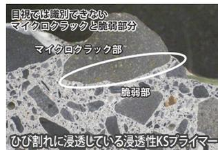
ひび割れに浸透している浸透性KSプライマー
