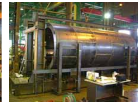
写真 - 1.3 覆工のリング拡幅実証実験
