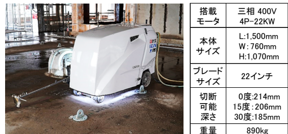
Fig.19 スラブ斜め切断カッターの仕様 (Specifications of Slab Diagonal Cutter Machine)
