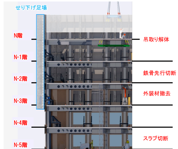
Fig.17 解体状況の断面図
