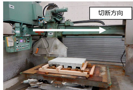
Fig.12 鉛直切断による試験体切断状況 (Status of Vertical Cutting Test)
