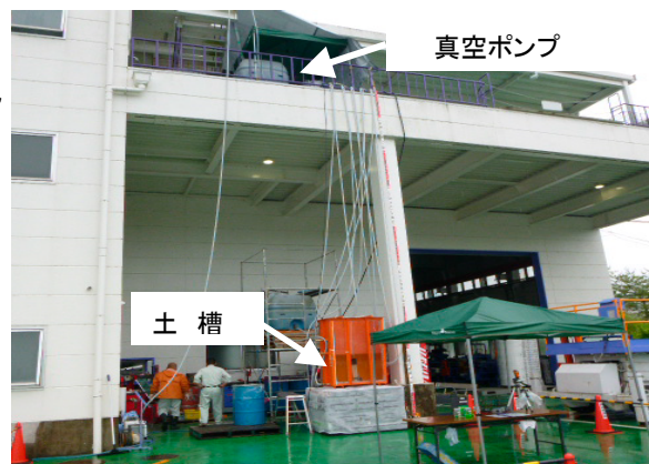
Fig. 5 土槽試験装置の概念図と試験状況
