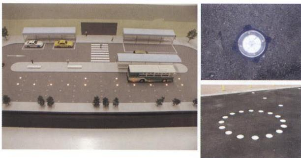
道路に埋め込まれた“光”により道路運用の高度化を図る「レーンライティングシステム」を開発
