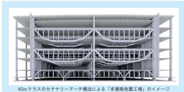
40mクラスのカーナリーアーチ構法による「多層階免震工場」のイメージ
