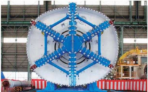
■ 地下鉄13号線用の複合円形断面シールド機が完成
