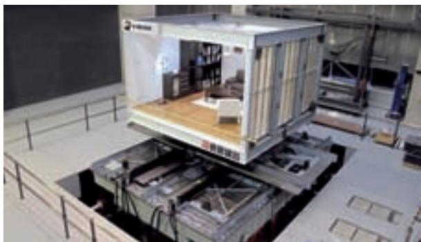
技術研究所に新方式の高性能3次元振動台
