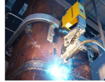
汎用可搬型 現場溶接ロボット
