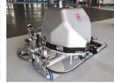
床コンクリート仕上げロボット Newコテキング®
