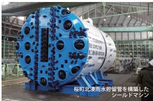
桜町北湊雨水貯留管を構築したシールドマシン
