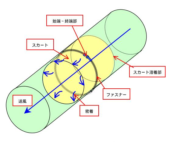
ファスナーの始端 ~ 終端部およびファスナー全体 を、内部に装備したスカートを送気で密着させて保 護し気密を保つ
