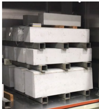
試験製造したCO 2 吸収コンクリート (地先境界ブロック)
