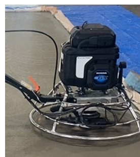
防音カバーを外した状態
