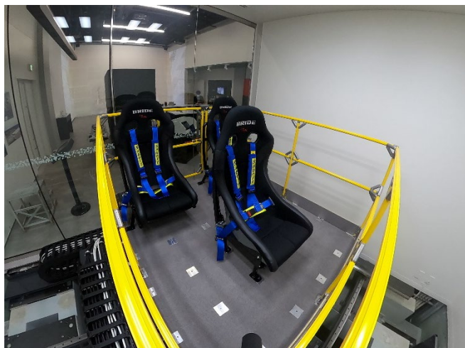
新たに開発した3次元振動台「トライデッカー」
