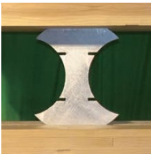
デザインされた制震ダンパ形状
