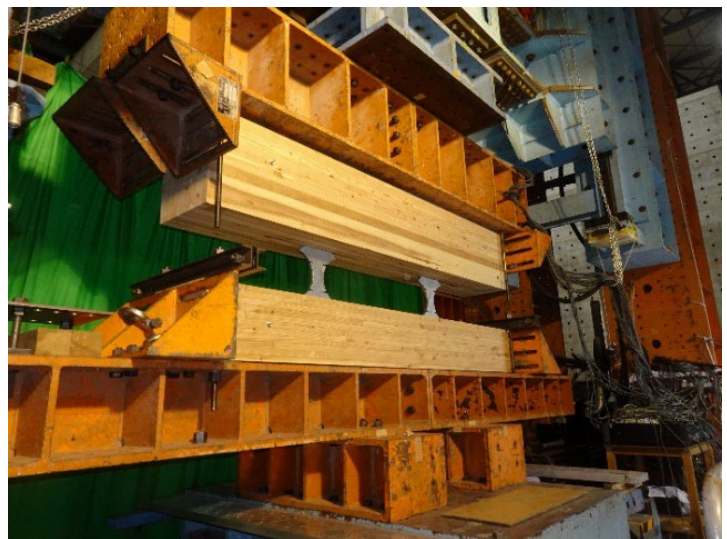
欄間制震システムの構造実験の様子
