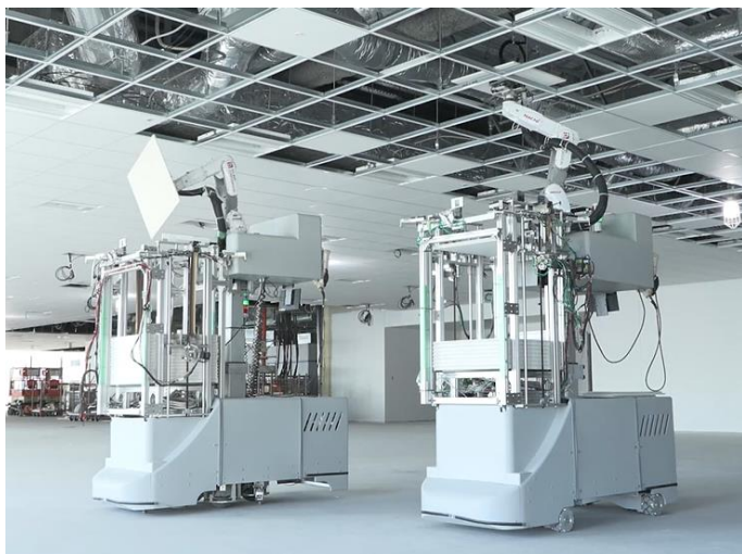
天井ボード取付ロボット
