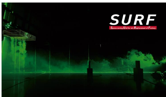
冷房空気が床面に沿って広がる様子 （気流可視化のため煙を使用）
