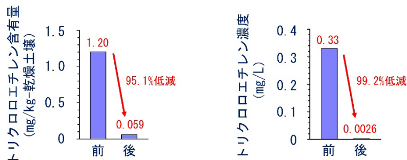
左: 土壌のトリクロロエチレン含有量の低減効果、右: 地下水のトリクロロエチレン濃度の低減効果 (FenMix 注入後 50 日経過)
