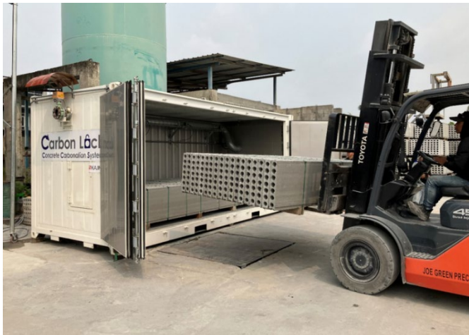
Carbon Lock にプレキャストコンクリート製品を搬入
