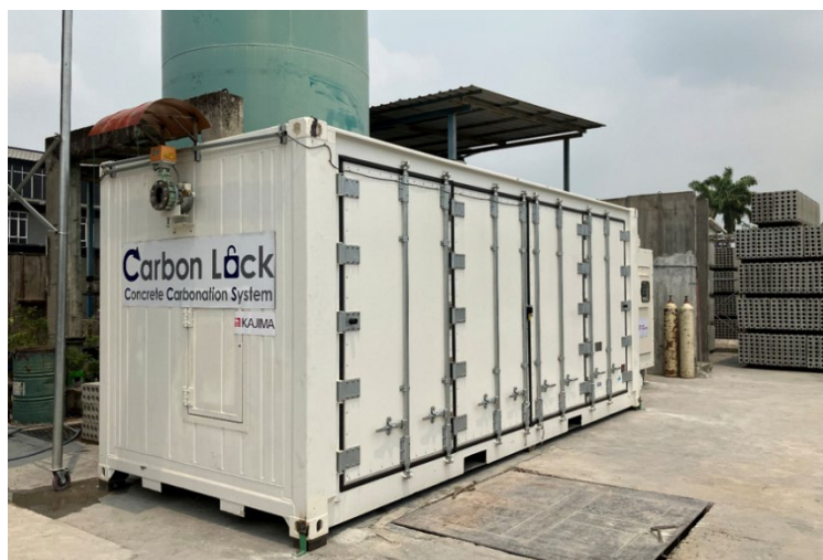
JOE Green 社のマレーシア・ジョホール工場に導入した炭酸化養生装置「Carbon Lock」
