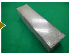
美シール工法で作製したコンクリート
