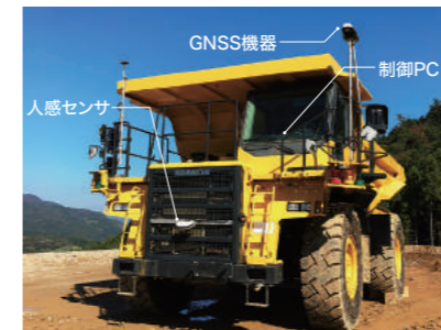
汎用ダンプトラックにGPS機器・制御PC等を搭載
