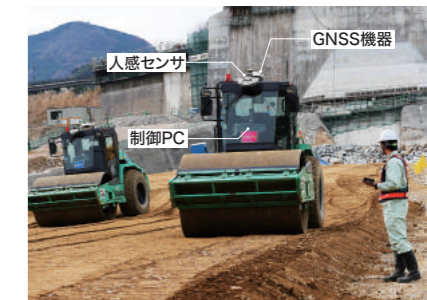
汎用の振動ローラに自動操舵装置・制御PCを搭載
