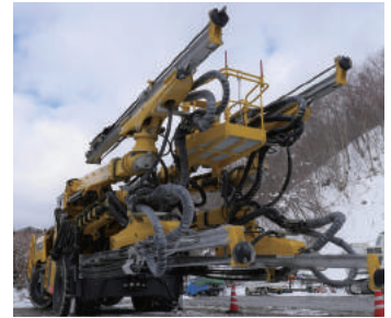
鹿島は、日本で初めて4ブーム・フルオートコンピュータジャンボを新区界トンネル（岩手県）の本坑掘削に適用しました。今後、トンネル施工に伴う一連の作業全体を自動化していくことを目指しています
