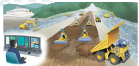
管制室から自動化重機に指示を出す
