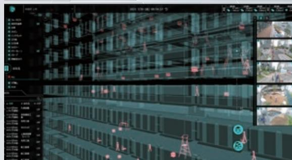
\*1 BIMを活用して資機材や人の位置を建物の3次元空間モデル上に表示し、リアルタイムで建設現場内の状態を可視化するシステム
