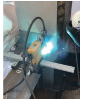
可搬型溶接ロボットによる超狭開先溶接
