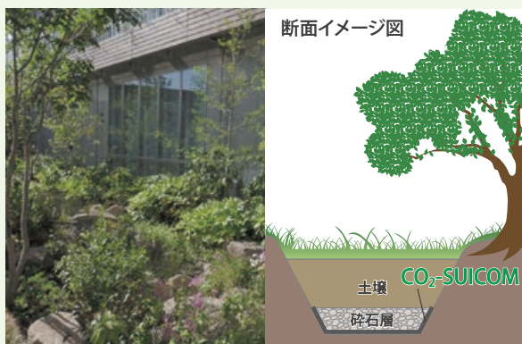
外構緑地システム「DEWレインガーデン®」の底板・側板にCO 2 -SUICOMを採用
