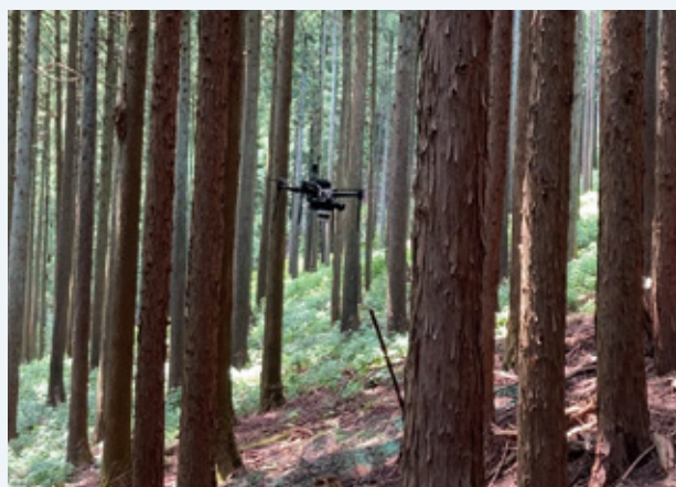
森林内自律飛行ドローンによる計測
