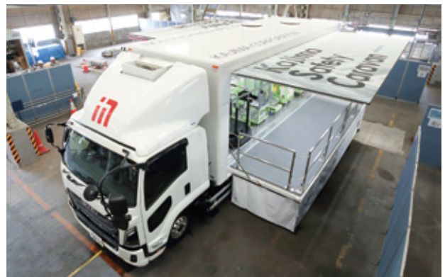
中型トラック(最大積載11t)をベースにした訓練車に、危険体感訓練の研修コンテンツ9種類を搭載
