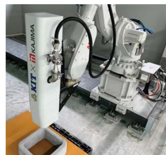
モルタルの積層状況
