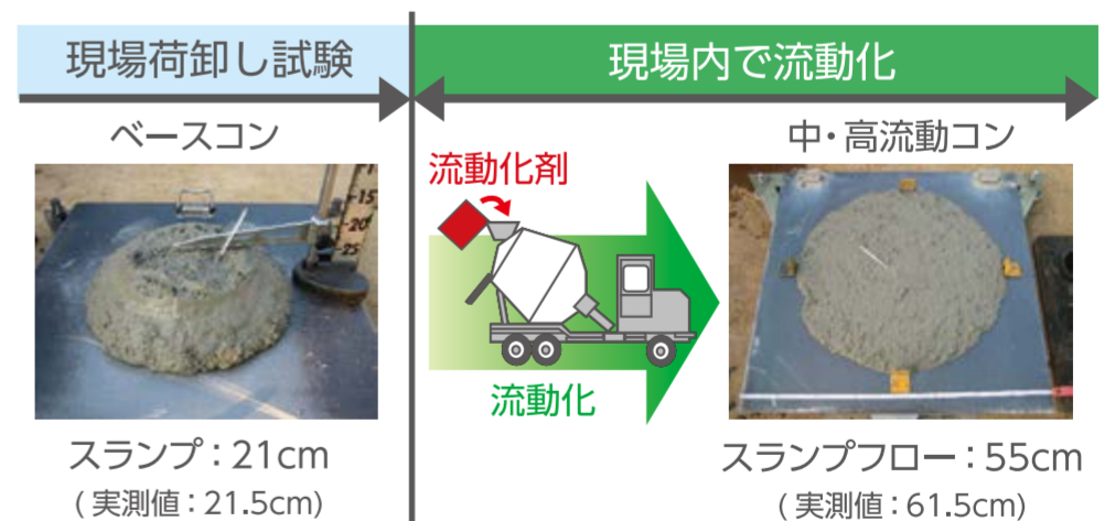
中・高流動コンクリートの製造方法
