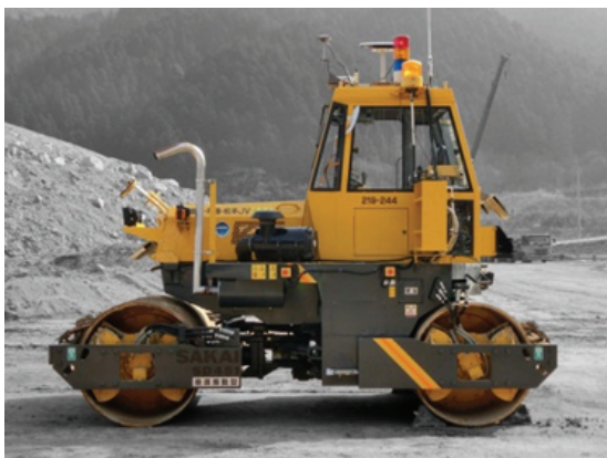
Photo 1 振動ローラ (Vibration Roller)
