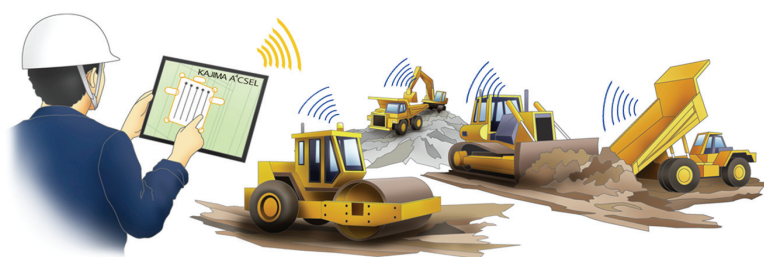
Fig.15 自動施工システム(A 4 CSEL)のコンセプト (Concept of Automatic Construction System- A 4 CSEL)
