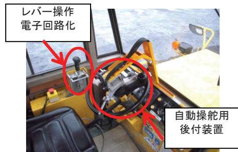
Fig.1 後付け自動制御装置 (Post-installation Type Automatic Device)
