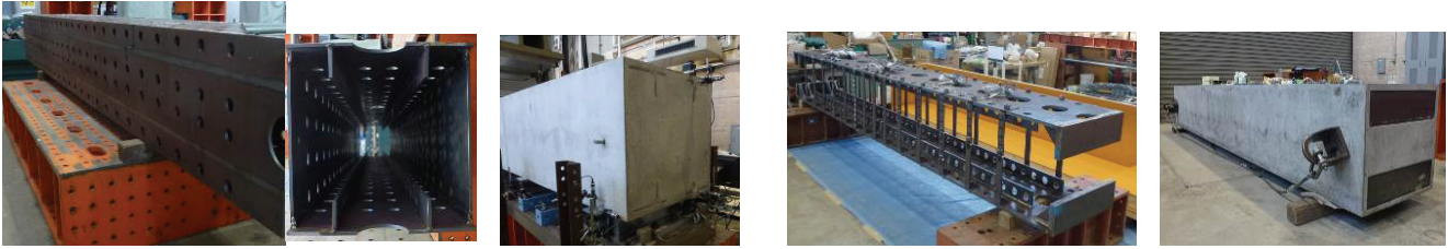
(a) 鋼材部分 (b)コンクリート打込み後 Photo 1 曲げ試験体 (Specimen for Bending Capacity Test)
