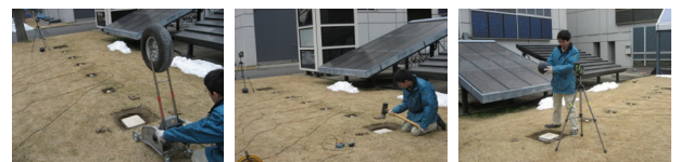
(a) バングマシン (b) インパクトハンマー (c) インパクトボール
