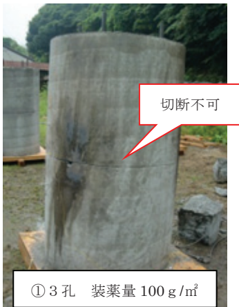
Photo 2 試験体実験①破砕結果 (No.1 Test Result)
