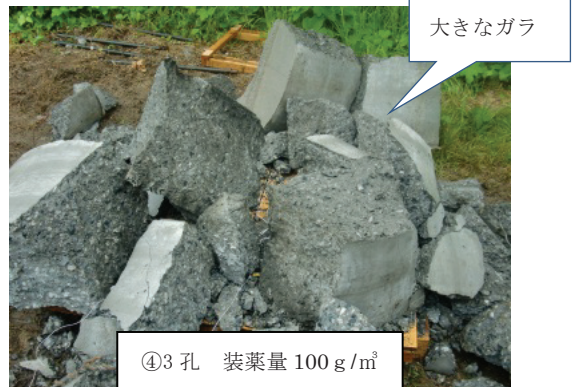
Photo 5 試験体実験④破砕結果 (No.4 Test Result)
