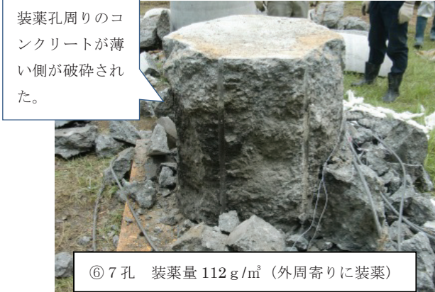
Photo 7 試験体実験⑥破砕結果 (No.6 Test Result)
