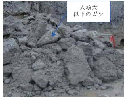
Photo 12 No. ④の破碎状況 (No. ④ Test Result)
