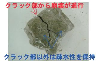
Photo 2 スレーキング試験後供試体
