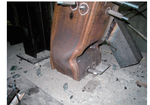
Photo 2 梁および柱の破壊状況 5) (Fracture of Beam and Column)
