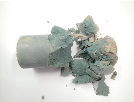
Photo 7 固化後の新型ボイドキーパー (New Type Void-Keeper after Solidification)
