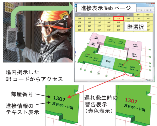
Fig.12 BIM による住戸内装工事の進捗表示例
