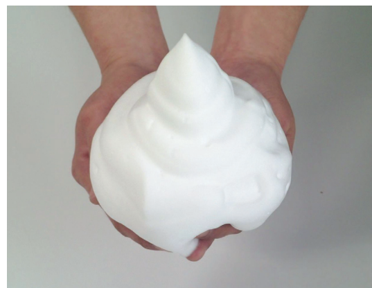
気泡シールド用の気泡（マジカルラスティングフォーム） Foams for Foam Shield Construction Method (Magical Lasting Foam)
