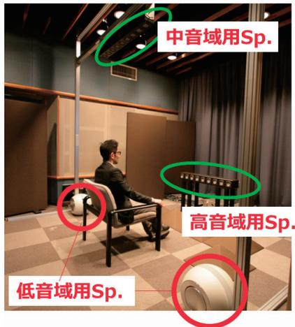
Fig. 9 リアルタイム立体音響再生装置の実際：高音域用のスピーカーが前方に、中音域用のスピーカーが上方に、低音域用のサブウーファが側方に配置されている
