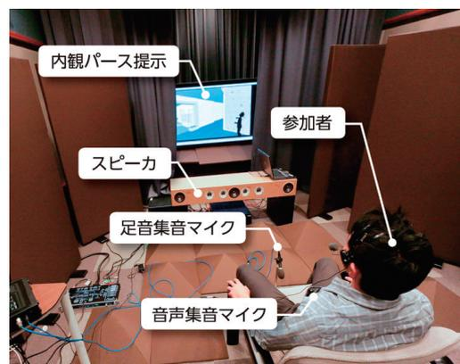
Fig. 11 西葛西井上眼科の音響設計に活用したリアルタイム立体音響シミュレータ(プロトタイプ)による足音のシミュレーションの様子
