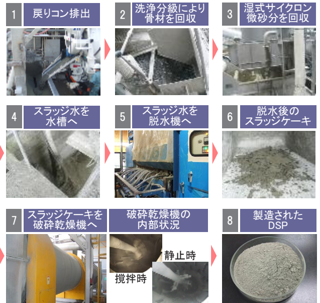
Fig.1 DSP の製造工程
