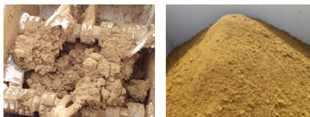
改質前 本補助材改質後(20 mm 通過) Photo 2 実験土壌と改質後土壌 (Experimental Soil and Improved Soil)
