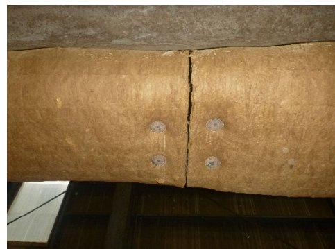
Photo 7 試験後のロックウールフェルト (Rock Wool Felt After Test)
