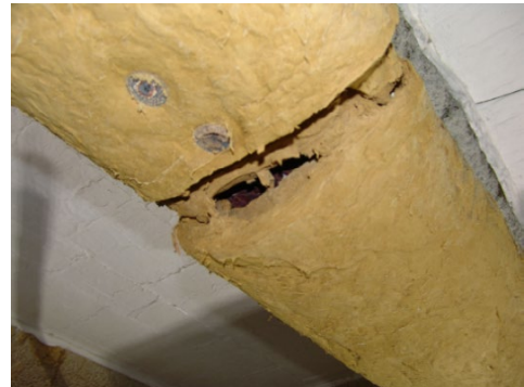
Photo 4 試験後のRWフェルトの開き (Rock Wool Felt After Test)
