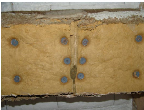
Photo 6 試験後の RW フェルト (Rock Wool Felt After Test)
