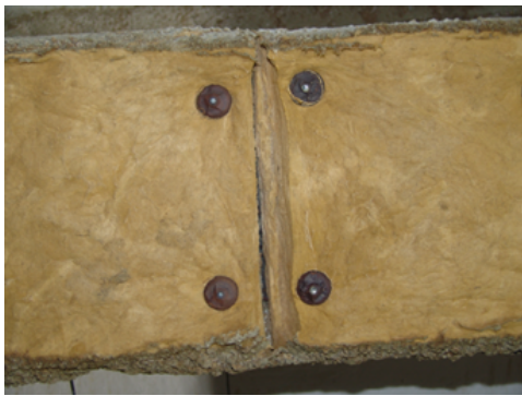
Photo 3 試験後のRWフェルトの開き (Rock Wool Felt After Test)
