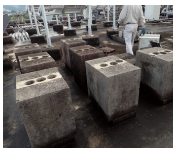
高炉スラグ高含有セメントの混合割合および試験体の暴露状況
