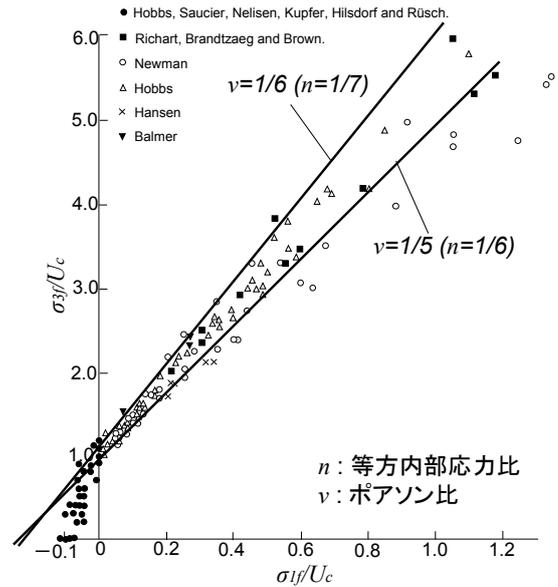
Fig.15 コンクリートの破壊面と実験値 Failure Surface and Experimental Data of Concrete<sup>7)</sup>
