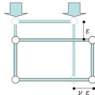
Fig.4 実際の1軸圧縮時の挙動 (Actual Behavior of Uniaxial Compress)
