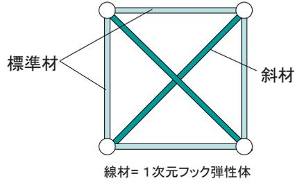
Fig.5 斜材モデル (Diagonal Model)
