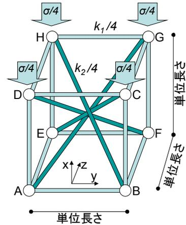
Fig.8 3次元斜材モデルによる1軸圧縮(Uniaxial Compress by Diagonal Model (3D))
