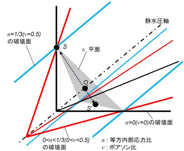
Fig.14 ポアソン比と破壊面 (3次元)
