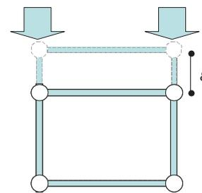
Fig.3 標準モデルによる1軸圧縮時の挙動 (Behavior of Uniaxial Compress by Standard Model)
