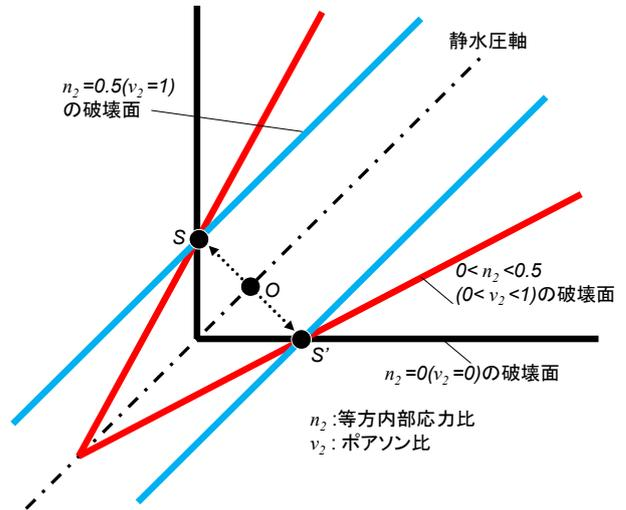
Fig. 12 ポアソン比と破壊面 (2次元)
