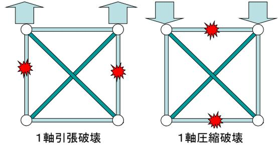
Fig.10 斜材モデルによる破壊 (Failure by Diagonal Model)
