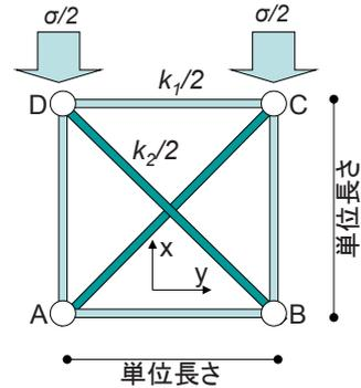
Fig.6 斜材モデルによる1軸圧縮 (Uniaxial Compress by Diagonal Model (2D))
