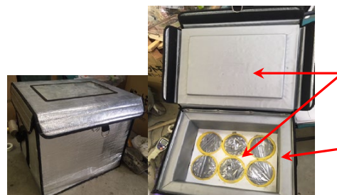
Photo 2 コンパクト養生箱によるコンパクト化法 (Compact Method Using Compact Curing Box)
