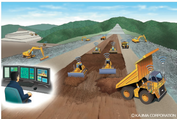
自動化施工システム(A 4 CSEL)の概要 Concept of Automated Construction System (A 4 CSEL)
