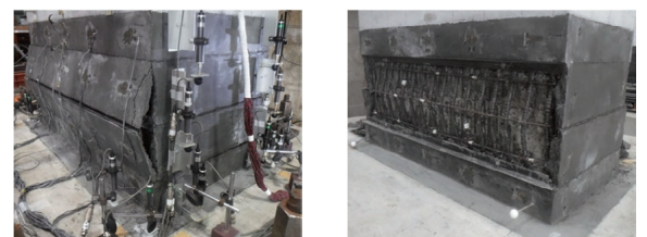
(c) No.3 (左: 6δ y -3 回目 右: 実験終了 かぶり除去後)
