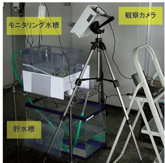
Photo 3 生物応答試験装置
