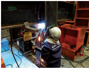
ロボット溶接の様子 Robot Welding
