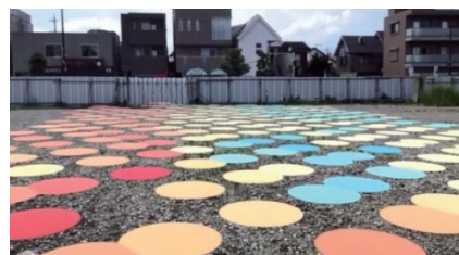
Fig.15 AR 上における \rho_d の表示のイメージ (Imaginary Diagram Display of Dry Density on Augmented Reality)
